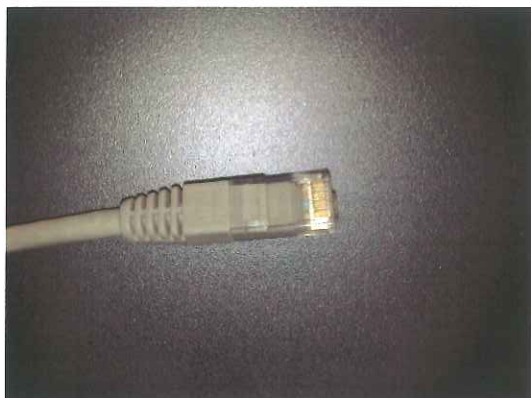
Conector tipo RJ45 Para conexión de tomas de red (equipos informáticos) y para tomas de voz (aparatos telefónicos)
